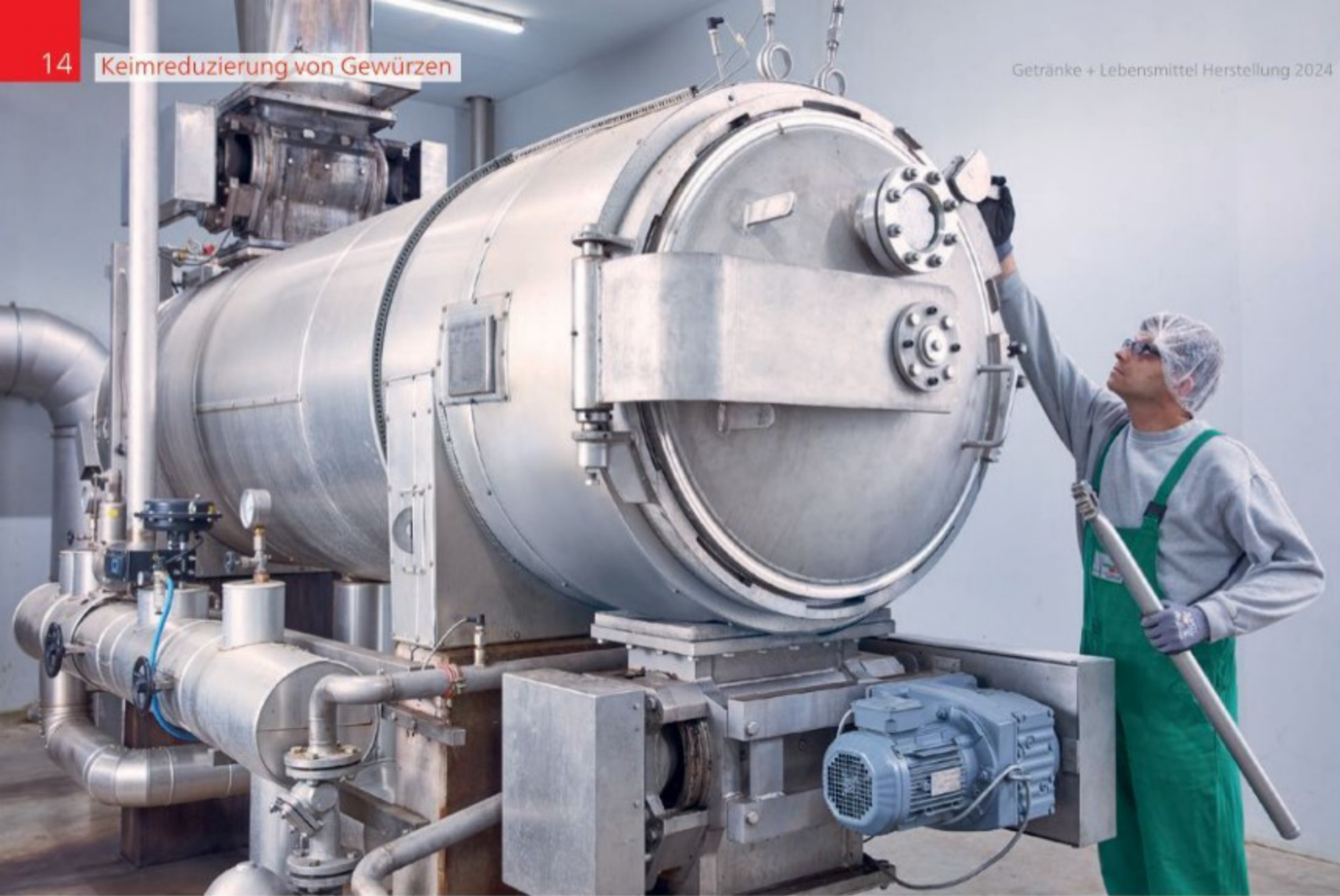
Die Keimreduzierung durch natürliche Dampfbehandlung sorgt für die geforderte Lebensmittelsicherheit der Produkte.
